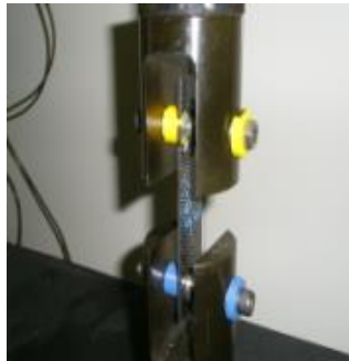
CFRP端板の引張り試験
