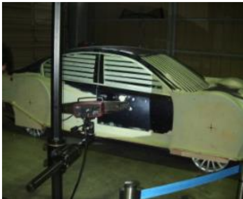
3次元非接触測定器 によるマスターモデルの測定
