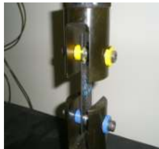
CFRP端板の引張り試験
