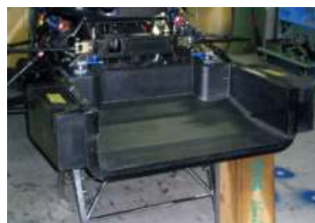
VEMAC ストラクチャー (ハニカムサンドイッチ構造)
